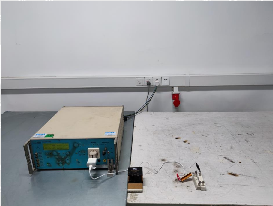
EN 61000-4-4/5/11 Test View
