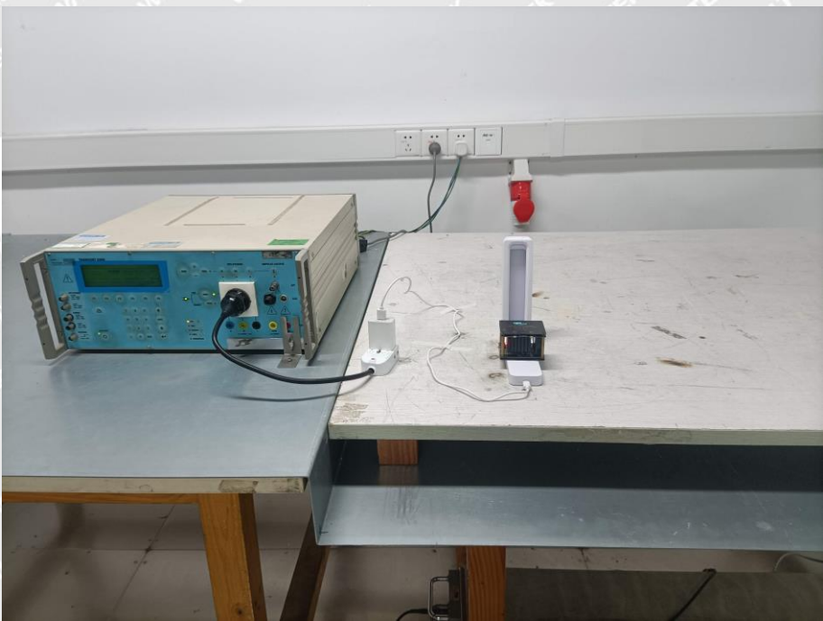
EN 61000-4-4/5/11 Test View
