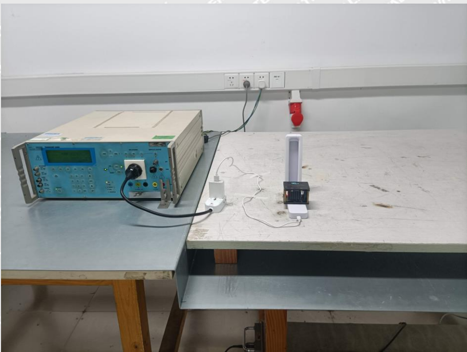
EN 61000-4-4/5/11 Test View
