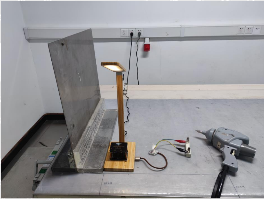
EN 61000-4-2 Test View
