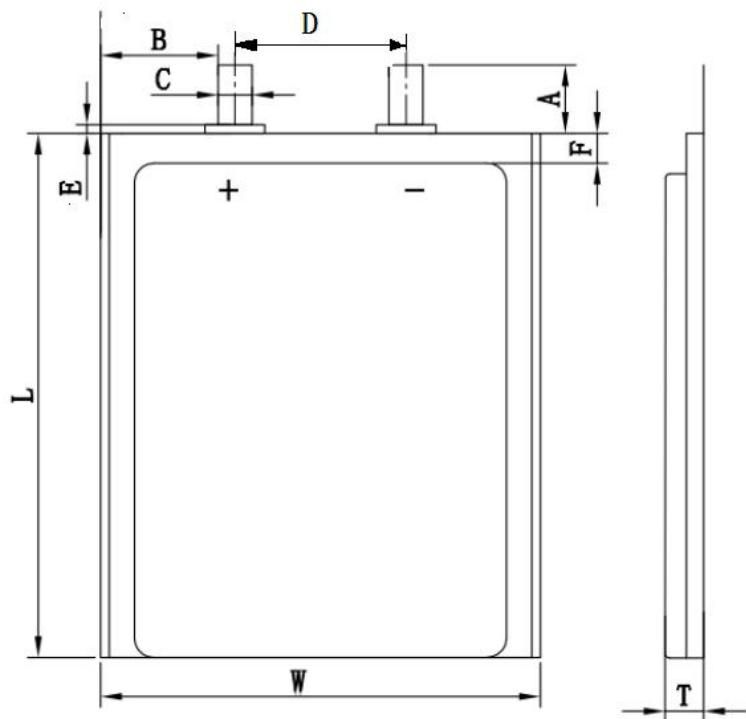
$T(\max.)$ :  $W(\max.)$ :  $L(\max.)$ =7.5mm: 65.0mm: 121.0mm
